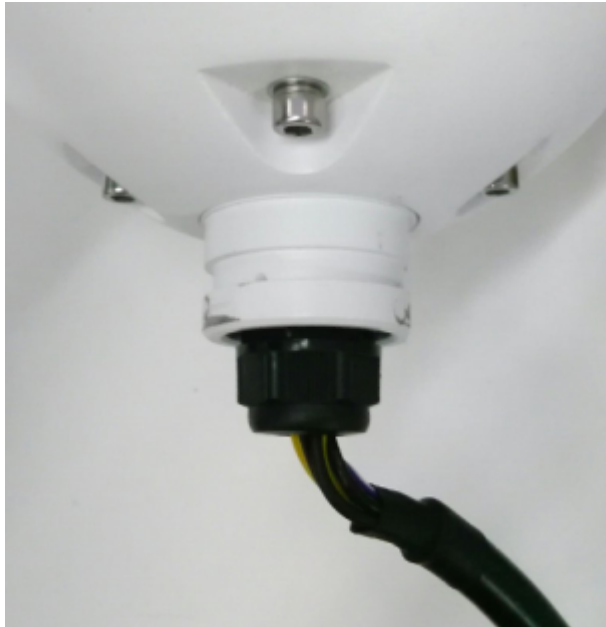
图 4-6 散线超出防水螺母
