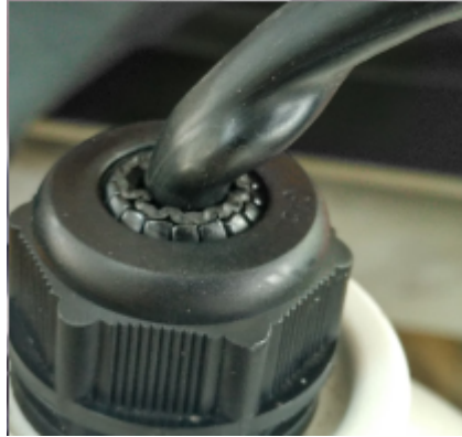
图 4-6 散线超出防水螺母
