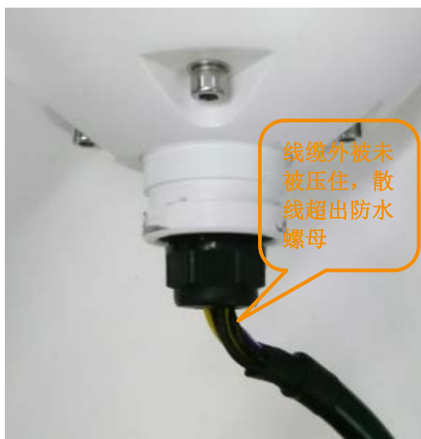
图4-6 散线超出防水螺母
