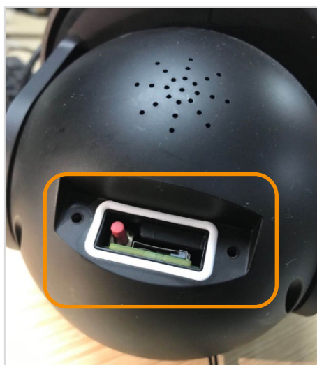
图4-8 密封圈正确安装
