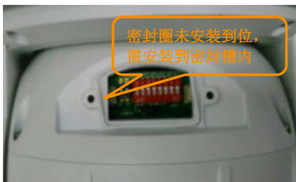
图4-8 密封圈正确安装
